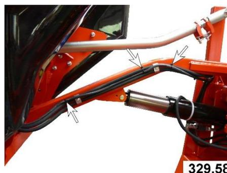
Die lange Halterung (E) auf der rechten Rückseite an der Fallenverstärkung mit der vorhandenen SKT-Schraube (F) befestigen. Steckdose (G) an der Halterung befestigen und die beiden Kabel gemäß Anschlußplan anschließen. Zur Befestigung unten eine Bohrung passend zur Halterung durch die Rückwand der Falle bohren. Halterung unten an der Falle befestigen.
