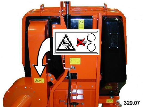
Niemals das Gebläse laufen lassen bei geöffneter Falle oder ausgehobenen Behälter. Es besteht Verletzungsgefahr durch geschleuderte oder fliegende Objekte.
