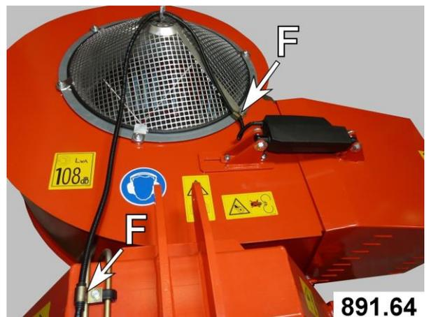
Kabel mit Schaltbox **(G)** zum Bedienerbereich im Traktor verlegen.
