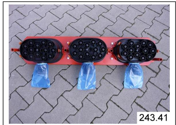
Filtereinsatz über die Führungsbolzen (**J**) einschieben und mit den Klemmhebeln (**A**) befestigen.
