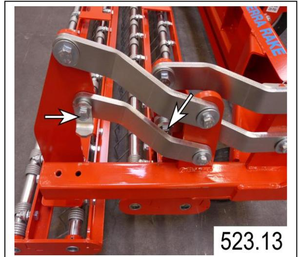
Zugfeder mit Augenschraube lang (C) von außen an Stelle der ausgebauten Schraube rechts mit U-Scheibe, Federring und Schraube befestigen (siehe Bild 523.14).
