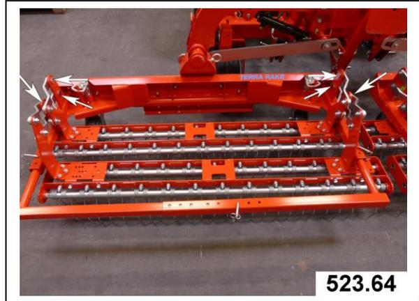
Federhalter I (A) rechts mit U-Scheibe, Federring und Schraube wie im Bild 523.11 befestigen.
