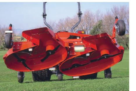
**FLEX CUT -** Für Wartungsarbeiten können die Mähdecks einfach hochgeklappt werden
