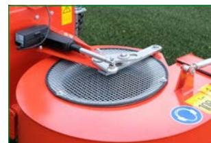
**Optionale elektrische 180° Verschwenkung der Ausblasdüse**
