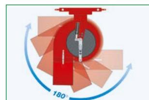
Stufenlose Verschwenkung der Ausblasdüse im Winkel von 180°.
