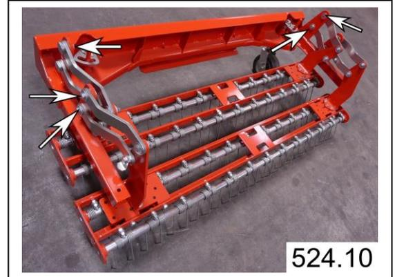
Fixer le support de ressort I (A) à droite avec la rondelle en U, la rondelle élastique bombée et la vis, comme illustré sur la figure 523.11.
