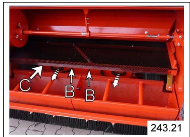
Fixer le tamis déposé sur la face frontale à la place du tamis fourni (taille de perforation = 5 mm).
