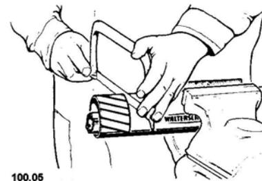
Arrondir les arêtes, enlever soigneusement les copeaux. Graisser le joint coulissant.
