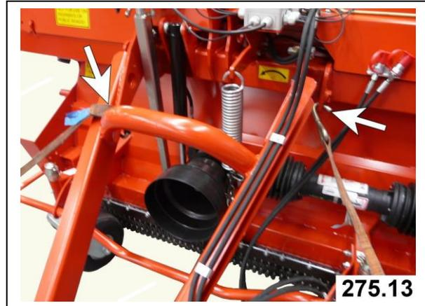
Point D : 1 à droite sur le cadre du train de roulement
