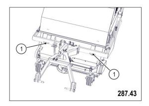
• Œillets d'arrimage (2) à droite et à gauche à l'arrière du châssis du véhicule
