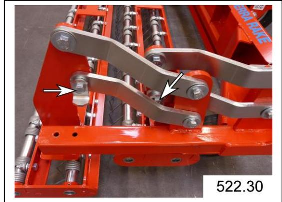
Fixer le ressort de traction au moyen de la vis à oeillet longue (C) depuis l'extérieur, à la place de la vis déposée à droite avec la rondelle en U, la rondelle élastique bombée et la vis (voir figure 522.31).
