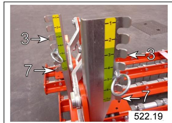
Accrocher les ressorts de traction (F) sur la position souhaitée au niveau des supports de ressort
