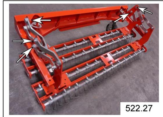
Fixer le support de ressort I (A) à droite avec la rondelle en U, la rondelle élastique bombée et la vis, comme illustré sur la figure 522.28.
