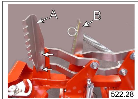
Fixer le support de ressort II (B) à droite avec la rondelle en U, la rondelle élastique bombée et la vis, comme illustré sur la figure 522.29.
