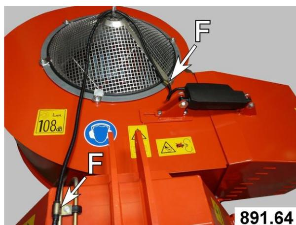
Poser le câble avec boîtier de commande **(G)** vers la zone utilisateur dans le tracteur.
