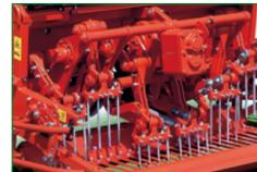
**Synchronisation de l'espacement** des trous avec la vitesse d'avancement par 3 vitesses.
