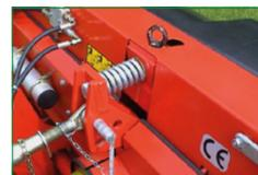
**Protection contre les risques d'endommagement** VibraStop/Powerpack sont des systèmes permettant d'amortir efficacement les chocs et les vibrations.
