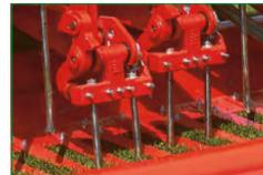
**Remplacement rapide des outils** au moyen de QuickFit, le système trèsconvivial permettant le montage et le démontage des outils.
