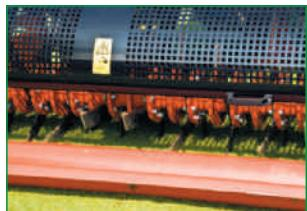
**Arbeitstiefen bis zu 200 mm** ermöglichen die Intensivlockerungs-Standard- oder Feinschnittmesser.
