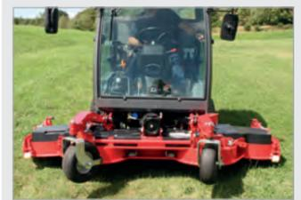
**Bodenanpassung durch flexibel gelagerte Seitenteile**
