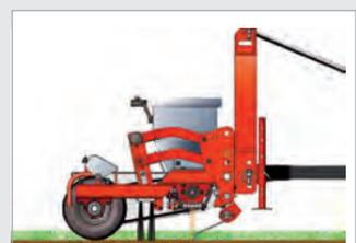
**Kurzer Abstand zwischen Saatgutauslauf und Bodenoberfläche**
